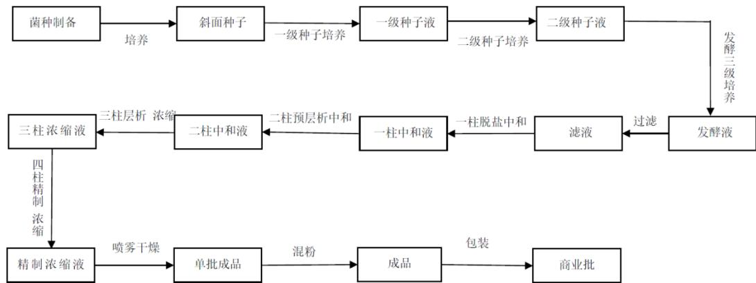
按照前述流程图，阿卡波糖的主要生产环节可概括为种子制备环节、发酵环节和提取精制环节等三大环节，其中种子制备环节对应工艺流程图中的“菌种制备”到“二级种子液”，发酵环节对应工艺流程图中的“二级种子液”到“发酵液”，提取精制环节对应工艺流程图中的“发酵液”到“精制浓缩液”。种子制备环节主要是对发酵菌种进行筛选和培育，使其生长为适合发酵的状态，发酵环节主要是为游动放线菌发酵创造出适合的环境和条件，使其发酵生产出阿卡波糖，提取精制环节主要是将生产出的阿卡波糖提取出来，去除其他杂质，获得质量达标的阿卡波
