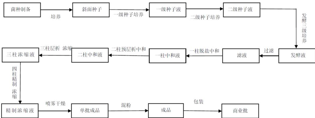
按照前述流程图，阿卡波糖的主要生产环节可概括为种子制备环节、发酵环节和提取精制环节等三大环节，其中种子制备环节对应工艺流程图中的“菌种制备”到“二级种子液”，发酵环节对应工艺流程图中的“二级种子液”到“发酵液”，提取精制环节对应工艺流程图中的“发酵液”到“精制浓缩液”。种子制备环节主要是对发酵菌种进行筛选和培育，使其生长为适合发酵的状态，发酵环节主要是为游动放线菌发酵创造出适合的环境和条件，使其发酵生产出阿卡波糖，提取精制环节主要是将生产出的阿卡波糖提取出来，去除其他杂质，获得质量达标的阿卡波糖，也称为产物的分离纯化。
