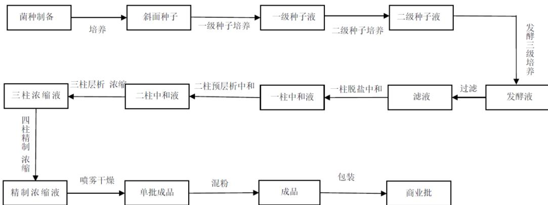
标的公司 2020 年产能提升主要是在发酵环节增加了 4 台发酵罐、4 台种子罐及发酵配套设施，对应工艺流程图中的一级种子液到发酵液的种子培养环节和发酵环节，提高了种子培养和发酵的能力；在精制环节增加 1 套连续离交脱盐系统，对应工艺流程图中滤液到一柱中和液的脱盐中和环节，提高了产品脱出无机盐、金属离子等物质的效率和能力，优化了精制工艺；在提炼环节增加 2 台压榨板框、1 套菌丝收集输送系统、9 根树脂柱等设备，对应工艺流程图中的滤液到四柱浓缩液的除杂和浓缩等环节，提高了杂质去除能力和浓缩提炼能力；在中控化验室增加检测设备，对阿卡波糖生产全过程中的产品情况进行检测，提高了产品检测能力。标的公司 2021 年技改扩能主要是在发酵环节增加了 2 台发酵罐及发酵配套设施，对应工艺流程图中的二级种子液到发酵液的发酵环节，
